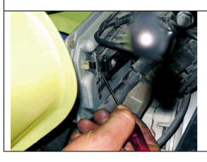
Um den großen Stecker des Telefonamts zu entblocken ist es notwendig mit einem Schraubenzieher zu lösen, den der Clip der Verzögerung im Stahl auf der talentierten Seite aufstellte.
