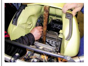
Um sich dem Telefonamt zu nähern, kann der Behälter des Kraftstoffs einfach angehoben werden oder genommenes getrenntgesamtes. In diesem letzten Fall aber, es ist zu d3connecter der Verdrahtung elektrische Arbeiter der Pumpe des Kraftstoffs und der kleinen Schläuche des Flusses vom Kraftstoff notwendig und gehabt wird dem vom Entweichen zu versperren Shrewdness, sich.
