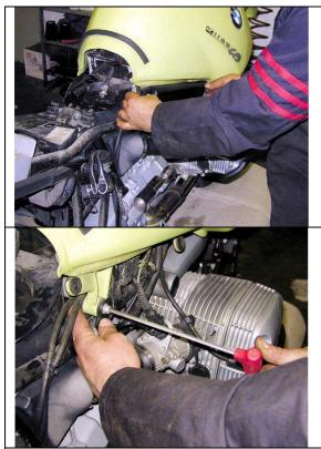
Die Installation von eprom der TRITON sieht den Ersatz des Spanes in der Zentraleinheit der Bosch Motronic ABER 2.2 vorher, aufgestellt unter dem Behälter des Kraftstoffs.
