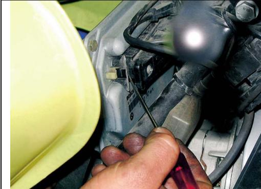
Per sbloccare il grosso connettore della centralina è necessario sganciare con un cacciavite la clip di fermo in acciaio situata sul lato destro.
